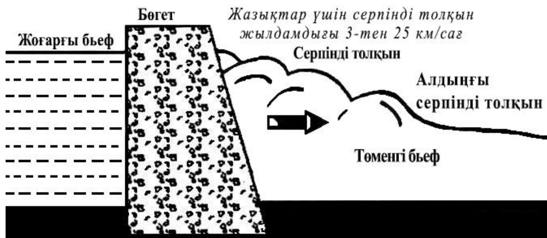
Сурет 5 – Кәдімгі гидродинамикалық апаттың модельдеу сұлбасы [5]
